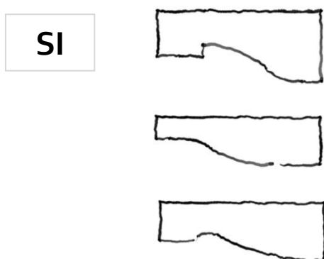
Esempi di modiglioni in pietra, da mantenere e/o ripristinare
